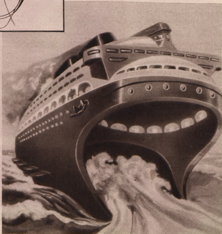
Model okrętu (na prawo) o niezwykle kształtach, poruszającego się z pomocą obrzucanej pompy (schemat powyżej), która wciągając wodę przez otwór na przodzie statku i wyrzucając ją bocznymi kanałami powoduje ruch okrętu.
