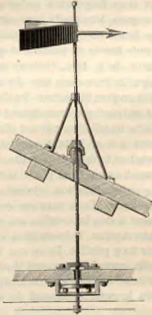
Fig. 52. — Installation d'une girouette.
