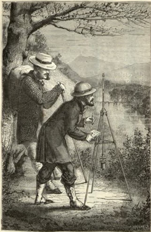
Fig. 20. — Installation du baromètre pour une observation en voyage.
