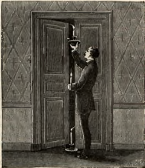
Fig. 50. — Formation des courants aériens par l'inégalité de température des couches d'air.
