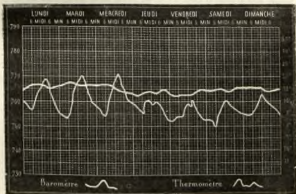
Fig. 25. — Les variations barométriques diurnes, dans l'intervalle d'une semaine, d'après le tracé du baromètre enregistreur.
