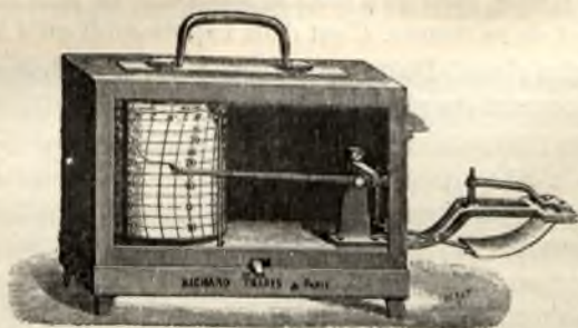
Fig. 8. — Enregistreur thermométrique de Montsouris.
