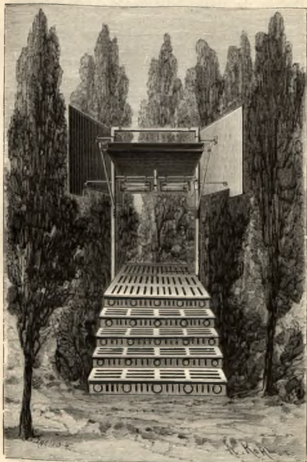
Fig. 7. — Abri des thermomètres à l'observatoire de Montsouris.
