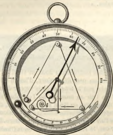
Fig. 34. — Hygromètre à cheveu de Monnier.
