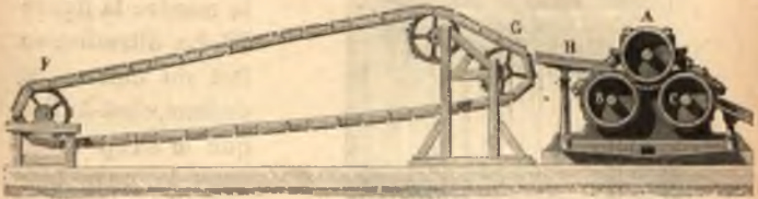
Fig. 76. — Moulin moderne des colonies. A,B,C, les cylindres en fonte.
