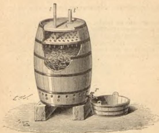
Fig. 253. — Fabrication du vinaigre par le procédé allemand.
