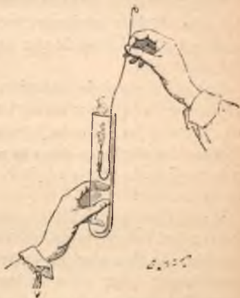
Fig. 141. — L'oxygène rallume une bougie présentant un point en ignition.
