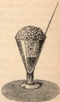
Fig. 281. — Calcaire décomposé par l'acide chlorhydrique.
