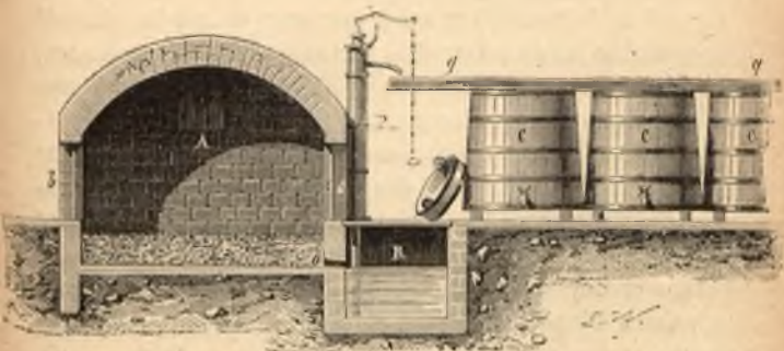
Fig. 252. — Foulage du raisin; A, cuve voûtée dans laquelle on piétine le raisin; R, réservoir du jus; P, pompe dirigeant le jus dans les cuves à fermentation.
