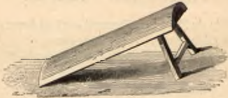
Fig. 109. — Chevalet pour le débouillage des peaux.
