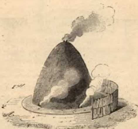
Fig. 94. — Meule garantie du vent avec des claies mobiles.
