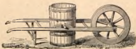
Fig. 284. — Brouette allemande pour le transport de la poudrette.
