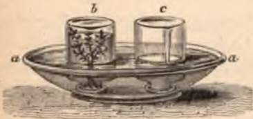
Fig. 140. — Appareil pour constater la décomposition de l'acide carbonique par la matière verte des feuilles.
