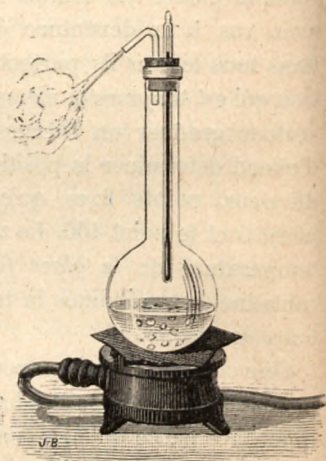
Fig. 108. — Détermination du degré 100 d'un thermomètre.
