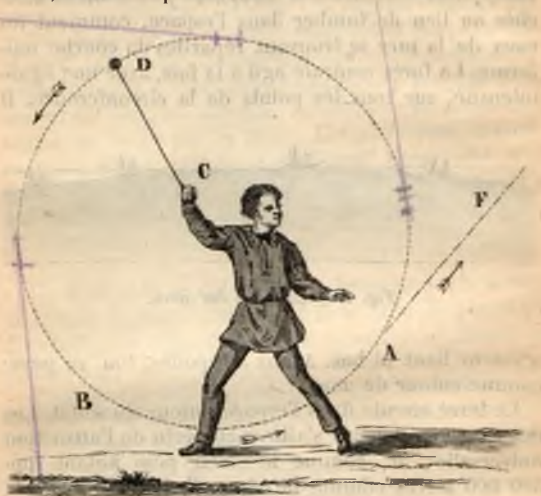
Fig. 5. — La fronde démontre la force centrifuge. ABD, cercle que parcourt la pierre; C, centre du cercle; A, point où elle est abandonnée; AF, direction qu'elle prend en s'échappant.
