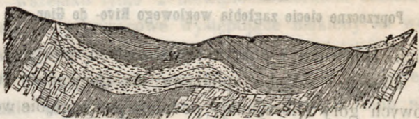
Poprzeczne cięcie podwójnego węglowego łęku w St. Pierre la Cour .
