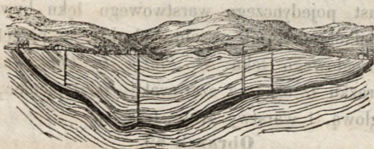
Poprzeczne cięcie zagłębienia węglowego Rive- de Gier.
