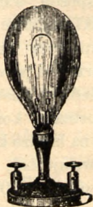
Fig. 213. Lampa żarowa o włóknie węglowym lub pla- tynowem.
