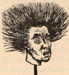
Fig. 322. Naelektryzowana głowa drewniana z włosami odtłuszczonemi.
