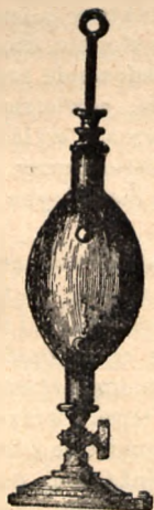
Fig. 324. Rurka opróżniona z biegunami wyładowującymi.
