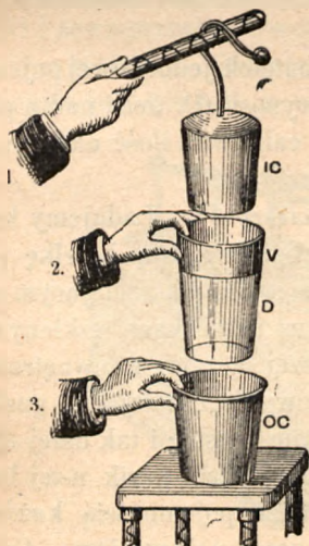
Fig. 332. Rozłączone części butelki lejdejskiej o zbrojach wysuwanych.
