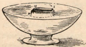
Fig. 85. Magnes na korku w naczyniu z wodą obraca się wyłącznie pod wpływem siły ziemi.
