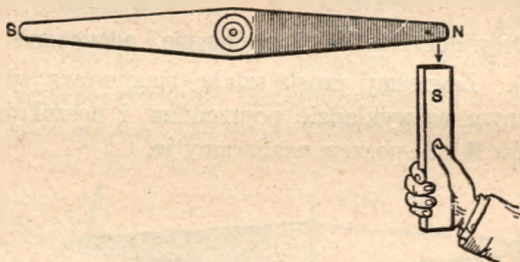
Fig. 26. Biegun S przyciąga biegun N.
