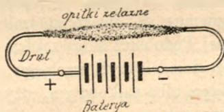
Fig. 107. Prąd, przebiegający po drucie, przyciąga opilki żelazne.
