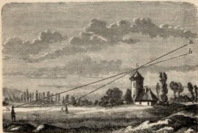
Fig 17. — Variation apparente dans la hauteur d'un objet, pour un observateur qui s'en approche ou s'en éloigne.
