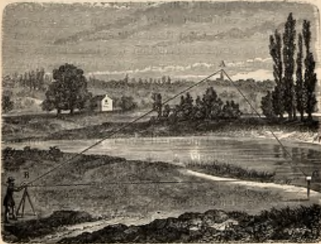
Fig. 15. — Mesure de la distance qui sépare un point d'un autre point inaccessible.
